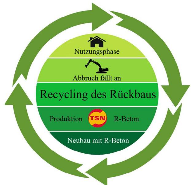
Die Umwandlung von Abbruchmaterial, welches für die Herstellung von R-Beton genutzt wird, spart Ressourcen und reduziert Transportaufwand.
